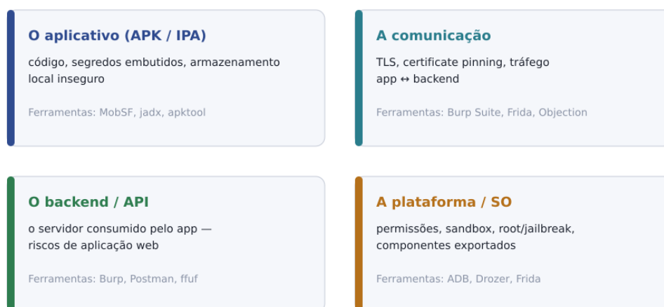
Figura — As quatro superfícies de ataque de uma aplicação móvel, e as ferramentas típicas de cada frente.
