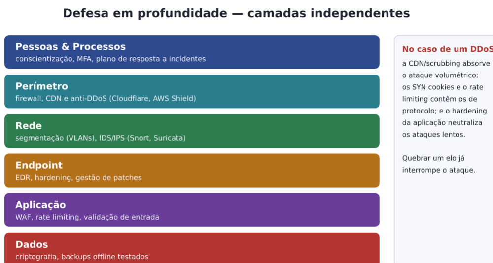
Figura — A defesa em profundidade: camadas independentes de controle. Um DDoS, por exemplo, é enfrentado em várias delas ao mesmo tempo.
