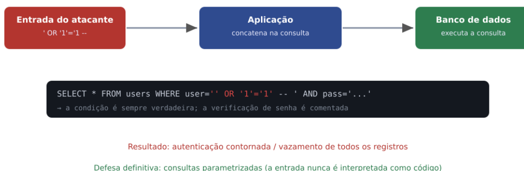
Figura — Anatomia de uma injeção SQL: a entrada do atacante escapa do contexto de dado e vira parte da consulta executada pelo banco.
